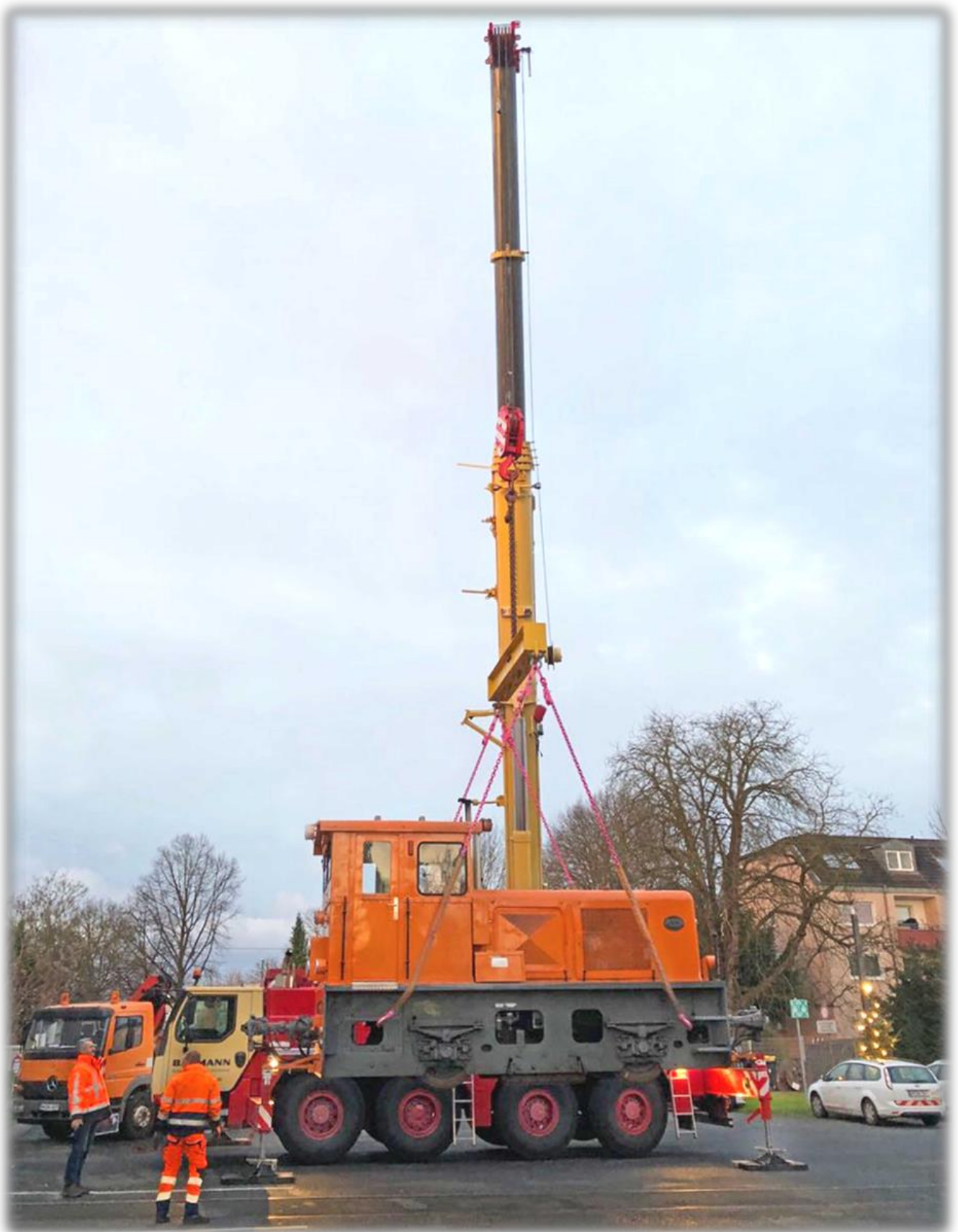
Der Transport der Lok 101 zur Hauptuntersuchung bei der Firma Westfälische Lokomotiven-Fabrik Hattingen Karl Reuschling GmbH & Co. KG, Hattingen ( WLH ) erfolgte am 13. Dezember 2017. Der Kran hatte sie so weit angehoben, dass der bereitstehende Tieflader darunter geschoben werden konnte. ■ Foto: Felix Much
